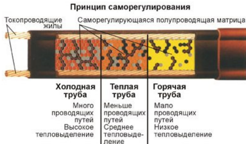
Рисунок 1. Конструкция саморегулируемого греющего кабеля
