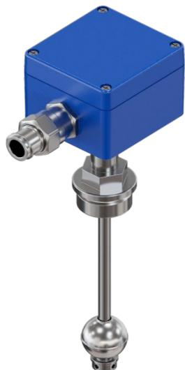
Поплавковый сигнализатор уровня LLS-F контролирует уровень жидкостей, срабатывая при достижении заданных значений. Надежен, прост в эксплуатации, не требует электропитания и подходит для агрессивных сред.
