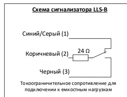
Работа сигнализаторов с индуктивной или емкостной нагрузкой может привести к разрушению геркона. Это, в свою очередь, может привести к нарушению работы последующего за ними блока управления и к опасности для здоровья человека и материальному ущербу. В случае наличия индуктивной нагрузки сигнализаторы должны защищаться емкостно-резистивным звеном или диодом холостого хода. В случае наличия емкостной нагрузки, необходимо подключение защитного сопротивления.
